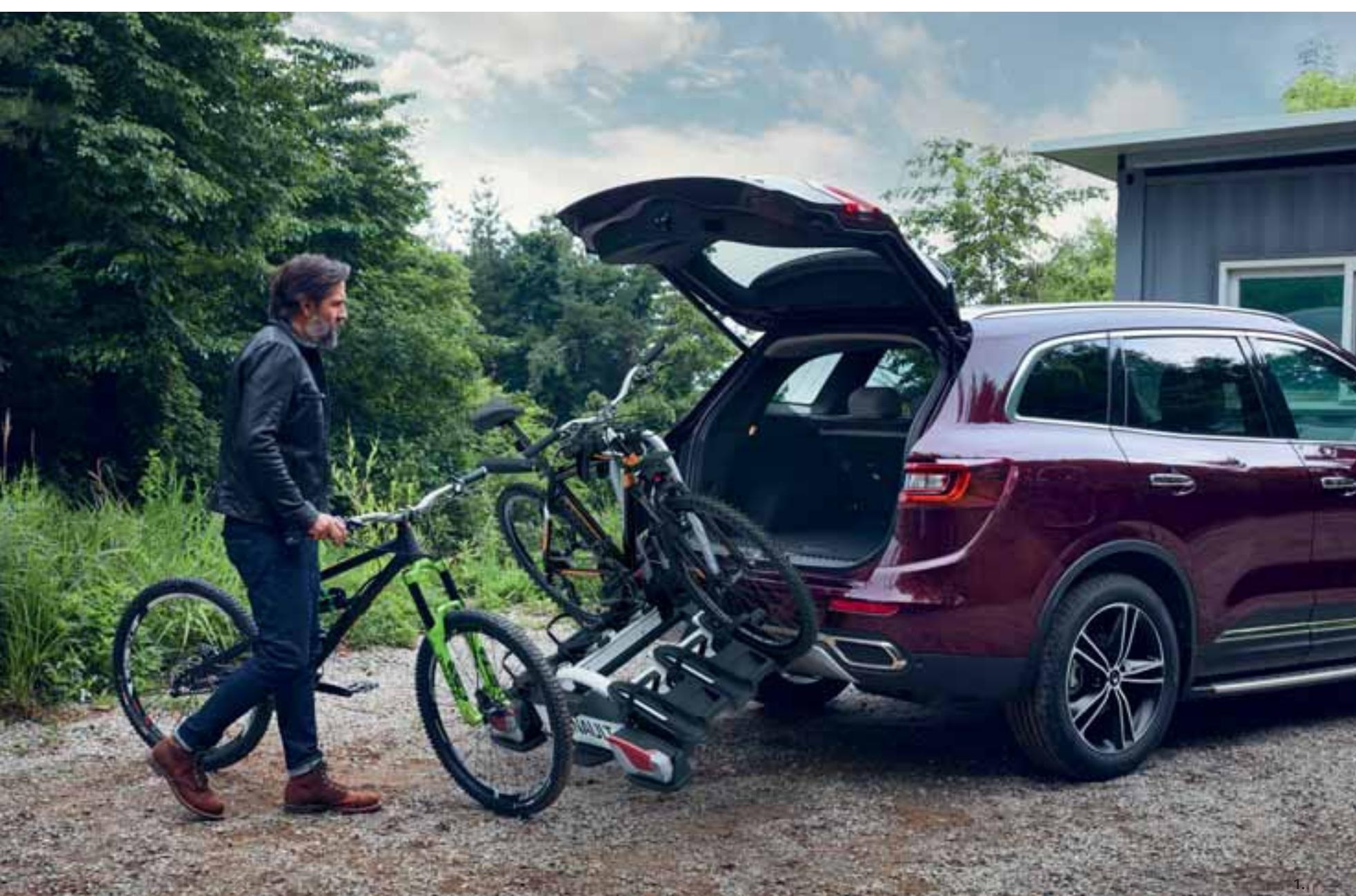
**1. Električna sklopiva kuka za vuču.** Ponesite brdske bicikle sa sobom za vikend ili priključite prikolicu na električnu sklopivu kuku za vuču. Kad vam kuka više ne bude potrebna, pritiskom na gumb u prtljažniku moći ćete je sakriti u samo nekoliko sekundi kako ne bi narušavala izgled vašeg novog Koleosa.
